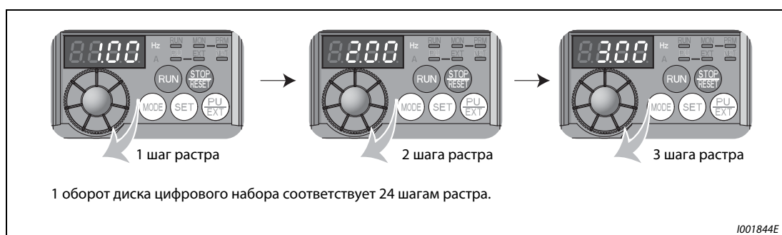
Рис. 6-159: Величина шага при настройке параметра 295 в "1,00"
