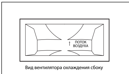
Рис. 8-4: Направление установки вентилятора охлаждения
